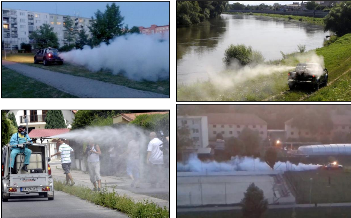
Obrázok 30: UVL aplikácia biocídov v obciach a mestách SR (hore a vpravo dole), aplikácia z korby auta vysokotlakovým postrekovačom v SR (vľavo dole)
